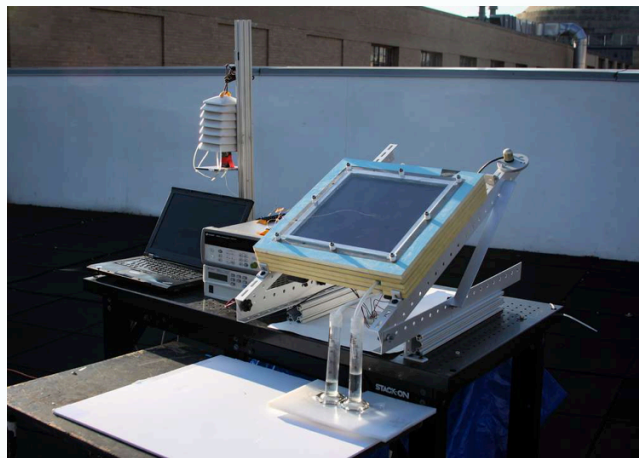
Photo 2 : Le nouvel appareil développé par Alina LaPotin et son équipe est capable d'extraire jusqu'à deux fois plus d'eau de l'air ambiant. Crédit Photo : © MIT, Alina LaPotin
