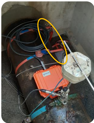
Comparaison Sonde à insertion sur conduite en fonte ductile DN 500.
