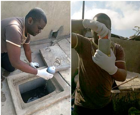
Prélèvement d'échantillons (eaux traitées et boues compostées) pour analyse dans une station de traitement d'Antananarivo (Madagascar).
