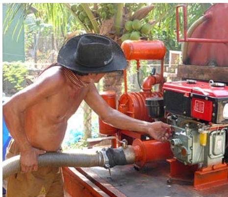
Pompe à vide montée sur un camion avec citerne au Cambodge.
