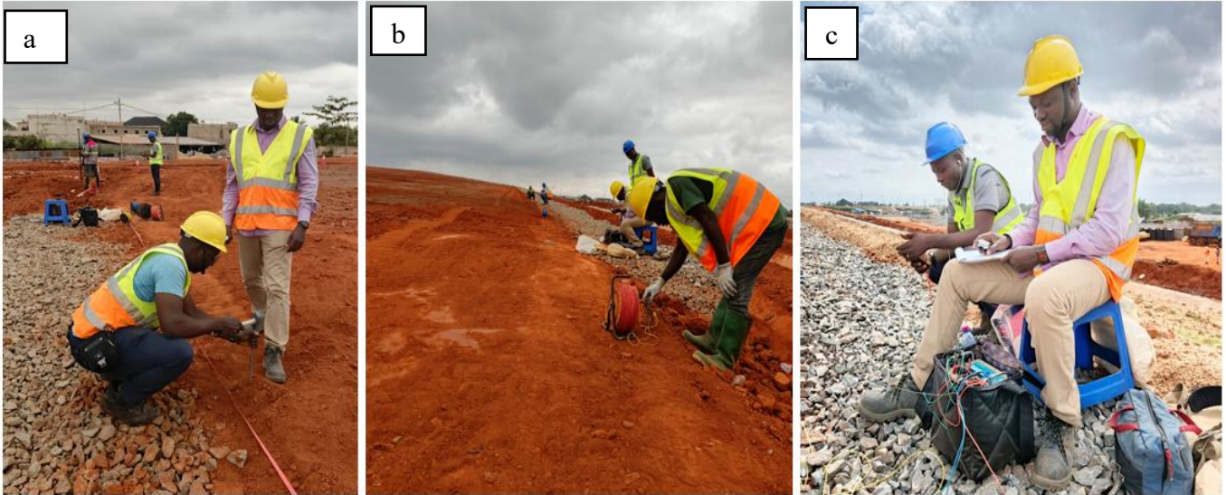
Planche 4 : Images illustrant les travaux de terrains de la TRE : a (Contact électrique de l'électrode avec le sol à l'aide d'un Marteau) ; b (Bobines) ; c (Électromètre) ; (Cliché PEKEYI, 2024).
