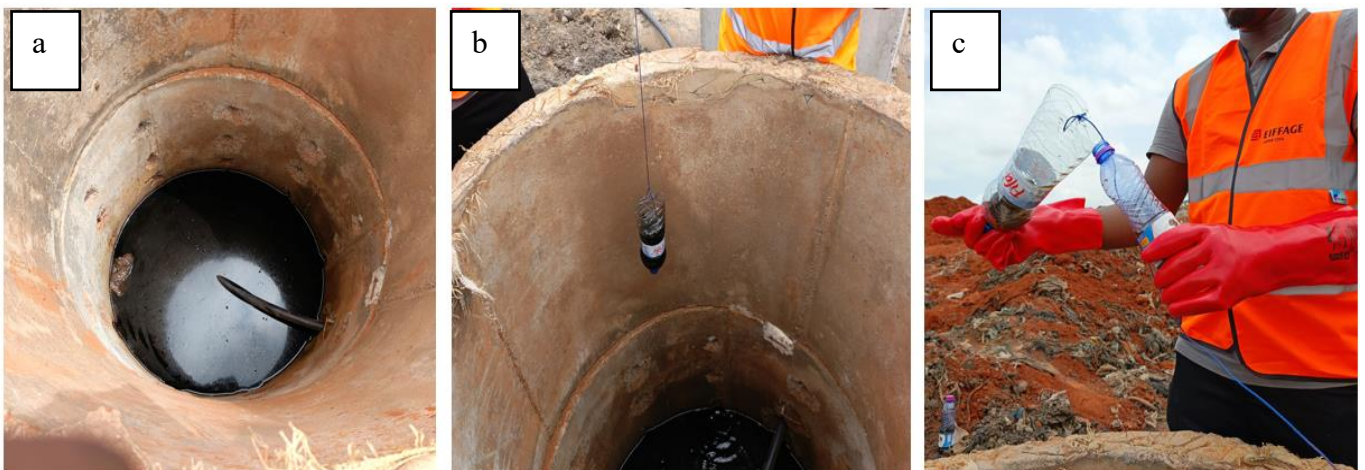
Planche 6 : Images indiquant les prélèvements du lixiviats sur l'ancienne décharge publique d'Agoè-Nyivé : a (Une tranchée drainante avec le flux du lixiviats) ; b (Un bidon auquel a été attaché une ficelle), c (Prélèvement du lixiviats) ; (Cliché PEKEYI, 2024).
