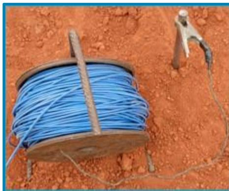
**Une câble de connexion avec son électrodes**
