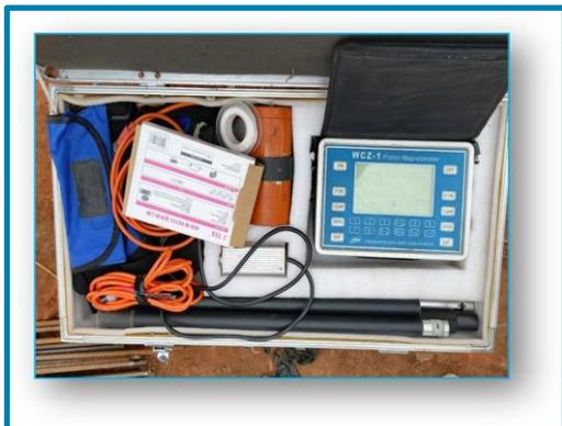
**Le Magnétomètre muni de ces accessoires**
